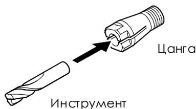
Вставьте цангу с инструментом в шпиндель. Затем придерживая инструмент, вращайте цангу чтобы закрепить ее в шпинделе.
