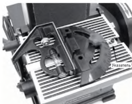
Рис. 12 Установка углового упора
